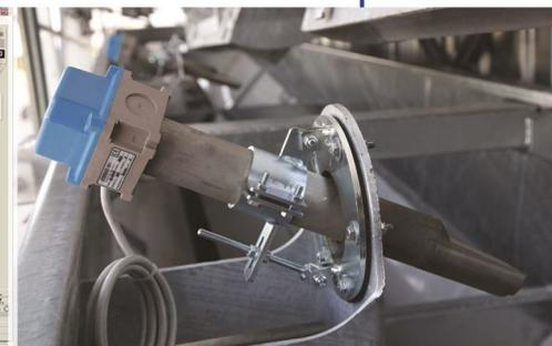
Sonda d'umidità - Moisture Probe
